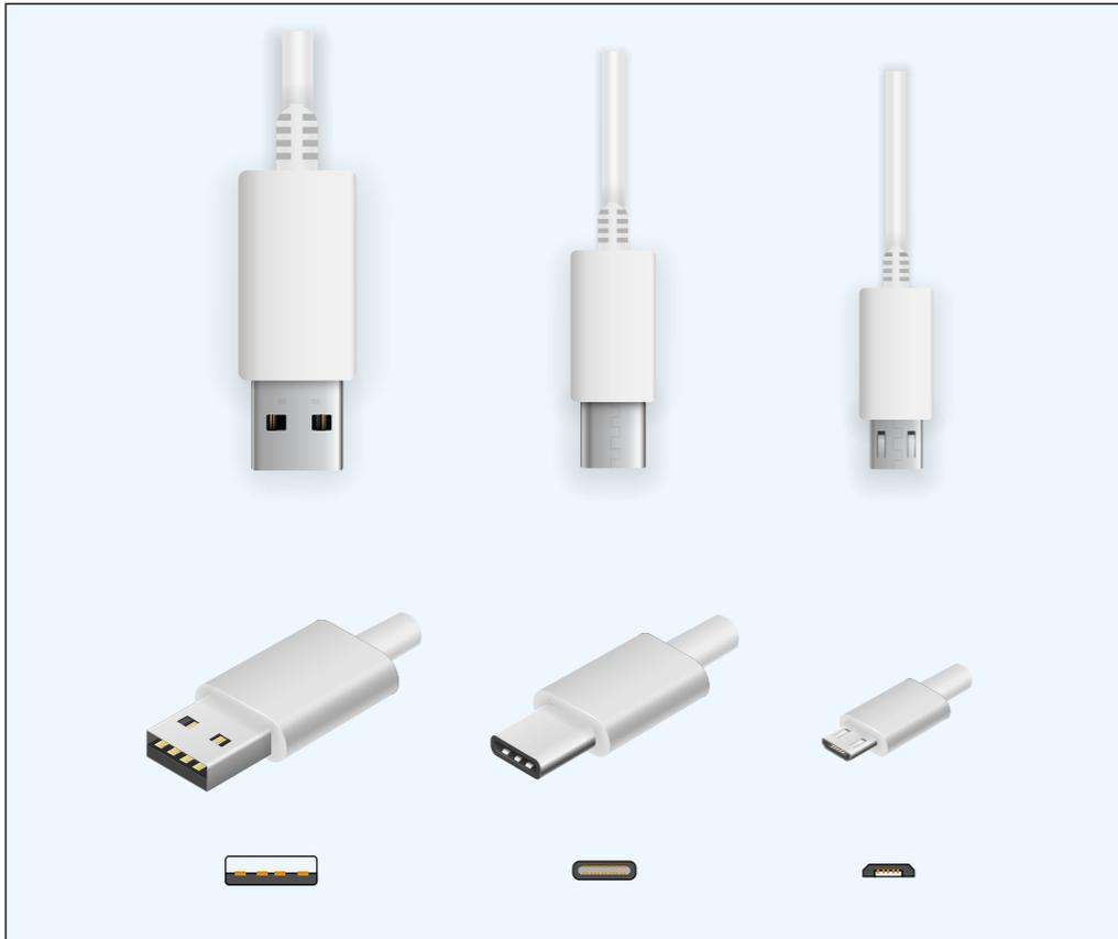
**Figura 1.9.** Conectores USB, Tipo C y miniUSB.
